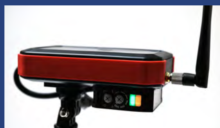
センサーの赤外線が反射板に当たるとオレンジ色も点灯し、音が止まれば準備OK
