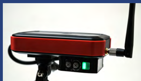
電源を入れると「ピッ、ピッ」という音と光電センサーの緑色が点灯
